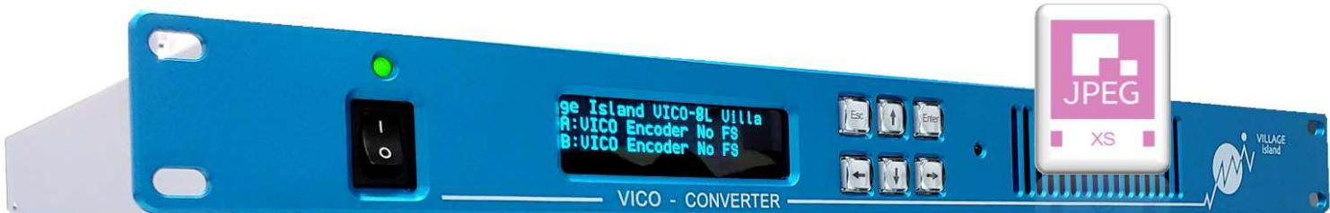
VICO-8L-XSはビジュアリー・ロスレス方式のJPEG-XSコーデックを搭載し、超低遅延量で、8K 映像信号をIP ST-2110-22で伝送します。モードを変更することで4K映像信号をIP ST-2110-22で伝送も可能です。データロスプロテクション用のST 2022-7 冗長機能(オプション)を備えており、1筐体で最大2信号(拡張オプション)のエンコードまたはデコードが可能です。エンコーダー、デコーダーのモードはフロントパネルよりユーザーが任意に切替を行うことができます。
